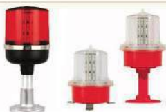
Mã SP: SAOL1; SAOL2; SAOL3; SAOLP2; SAOLP3 Loại: Đèn LED cường độ thấp; Loại ổn định 17cd ± 25% Điện áp định mức: DC: 12V, 24V; AC: 110V ~ 220V Kích thước: Đường kính: Ø115mm; Chiều cao: 275mm Chất liệu: Ống kính: PC; Vỏ ngoài: PC; Giá đỡ: Nhôm Chống nước: IP56
